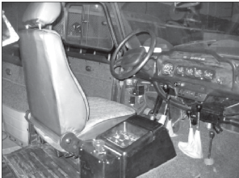
Рис. 3. Размещение пульта и блока управления режимами электромашины и распределительной панели в кабине машиниста
