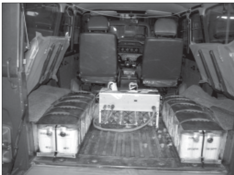
Рис. 4. Установка на автомобиле блока преобразования энергии и управления, блоков силовой коммутации и АБ
